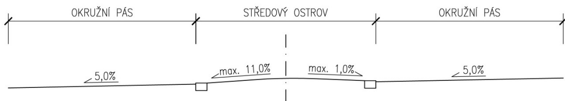
Obrázek 4 - Okružní pás na nakloněné rovině – příklad návrhu okružního pásu ve sklonu 5 %.
