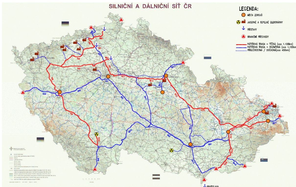
Obrázek 38 - Mapa navrhovaných páteřových tras pro přepravu těžkých a rozměrných nákladů dle metodiky Přeprava těžkých a rozměrných nákladů v ČR – síť silničních páteřových tras pro jejich přepravu.
