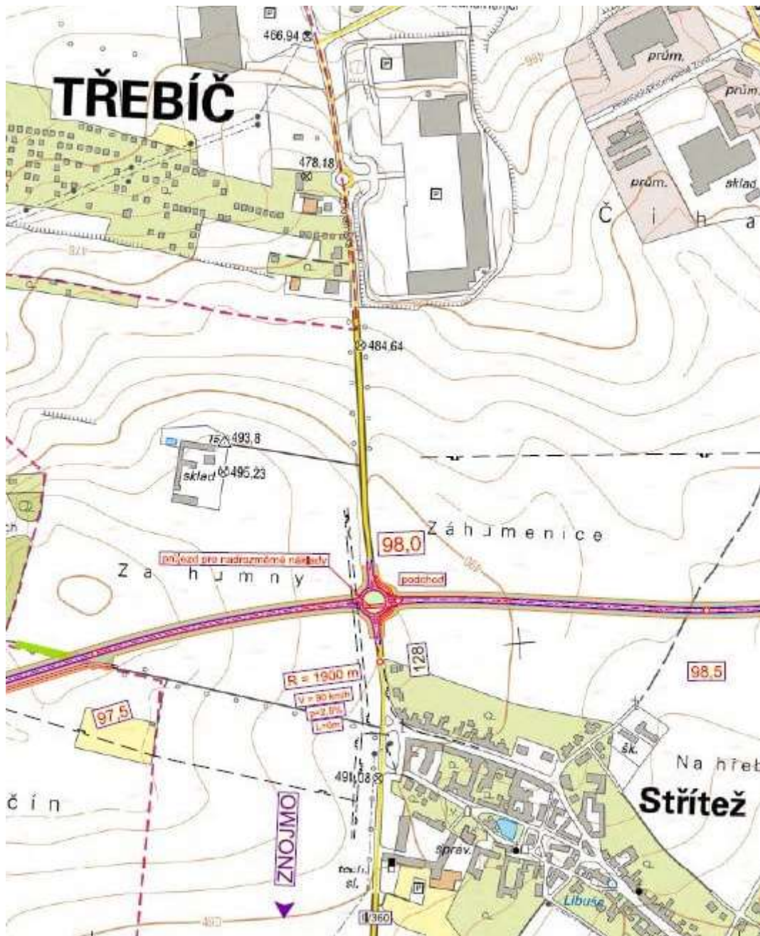
Trasa přeložky silnice I/23 v tzv. exogenní trase v subvariantě s okružní křižovatkou na II/360 u obce Střítež (Ing. Jiří Kalčík, 12/2025)
